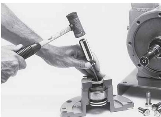
**ВНИМАНИЕ:** Вышеприведенная фотография сделана на разрезе для лучшей иллюстрации. Снять кольцевое уплотнение головки и поместить головку на верстак, как это показано на рисунке. Легким постукиванием выбить уплотнение из головки с помощью длинной отвертки через отверстие крышки подшипника. Проверить внутреннее манжетное уплотнение и извлечь его, если это необходимо, с помощью такой же методики.
