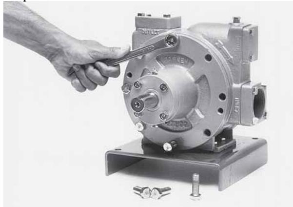
Затянуть болты головки по диагонали. Нет необходимости разбирать или повторно устанавливать шайбы на крышки подшипников. Повторить все вышеизложенные этапы при замене узла уплотнения на другой стороне.
