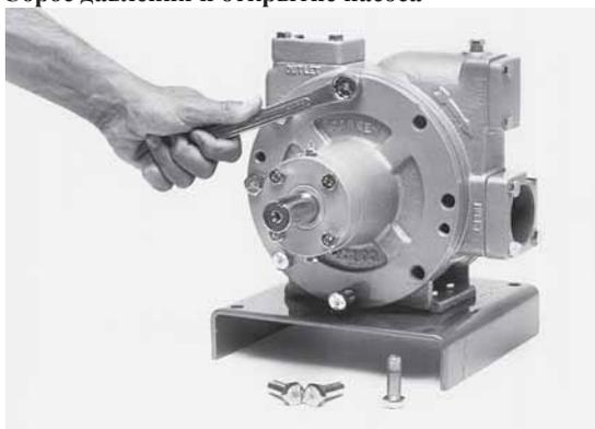
Ослабить болты головки и снять одну головку с прикрепленной крышкой подшипника, при этом удерживая ее на валу.
