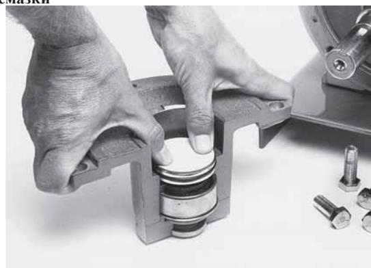
**ВНИМАНИЕ:** Вышеприведенная фотография сделана на разрезе для лучшей иллюстрации. Вывернуть головку и установить новое уплотнение консистентной смазки, повернув его вниз и вдавив его в просверленное отверстие позади главного подшипника. Это лучше сделать с использованием старого седла уплотнения со снятым кольцевым уплотнением. Нанести обильное количество легкого смазочного масла на новое седло уплотнения. Используя защитный диск, осторожно вжать уплотнение на место.
