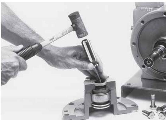
**ВНИМАНИЕ:** Вышеприведенная фотография сделана на разрезе для лучшей иллюстрации. Снять кольцевое уплотнение головки и поместить головку на верстак, как это показано на рисунке. Легким постукиванием выбить уплотнение из головки с помощью длинной отвертки через отверстие крышки подшипника. Проверить внутреннее манжетное уплотнение и извлечь его, если это необходимо, с помощью такой же методики.
