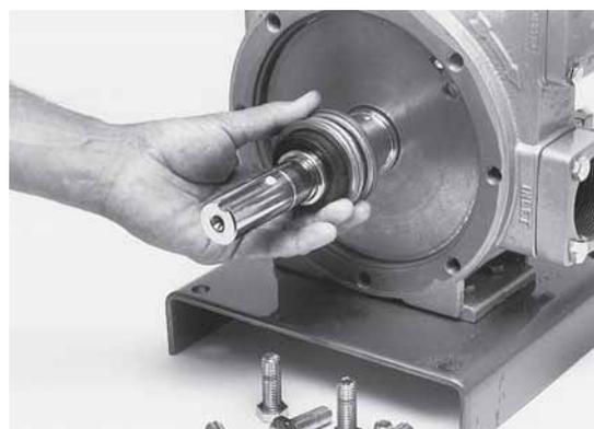
Извлечь узел старого уплотнения из вала насоса, при этом нажимая на рабочий диск насоса. Это позволит узлу стопора уплотнения быть извлеченным без вытягивания вала ротора из насоса.
